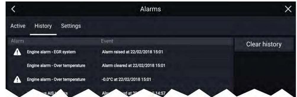
Alle roten (Gefahr) und orangefarbenen Alarme (Warnung) werden in der Alarmhistorie aufgelistet. Die Historie enthält jeweils einen Eintrag für das Auslösen eines Alarms und einen für dessen Quittierung. Die Spalte „Alarm“ zeigt den Namen des Alarms und die Spalte „Ereignis“ enthält Einzelheiten zu der Alarmbedingung sowie Datum und Uhrzeit des Alarms.
