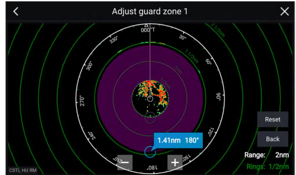
Richten Sie die Überwachungszone auf die gewünschte Größe ein, indem Sie die Endpunkte des inneren und des äußeren Rands (Kreise) an die gewünschte Position ziehen.
