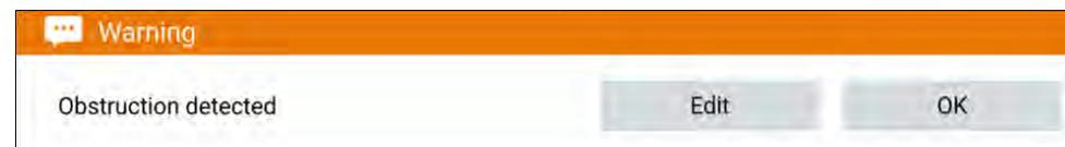
Wenn der Hindernisalarm ausgelöst wird, wird auf dem MFD eine Meldung angezeigt und ein Signalton ausgegeben. In der Meldung auf dem Bildschirm können Sie den Alarm quittieren, indem Sie *[OK]* wählen, oder Sie können die Alarmparameter bearbeiten, indem Sie *[Bearbeiten]* wählen.
