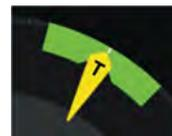
Beim Segeln können Sie den Windwinkel so wählen, dass er der Mitte des Windwinkelziels entspricht, um beim Kreuzen aufwindwärts oder beim Halsen abwindwärts Ihre effektive Geschwindigkeit auf ein Ziel (VMG) zu maximieren.
