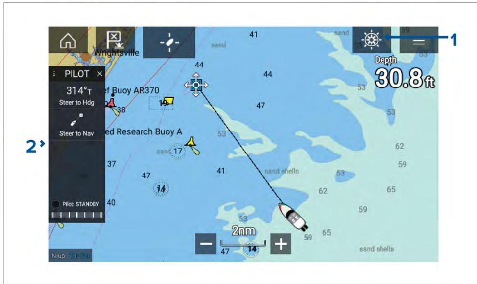
1. [Autopilot-Symbol] – Wenn [Autopilot-Steuerung] aktiviert ist, wird das Autopilot-Symbol auf dem Bildschirm angezeigt. Wählen Sie das Symbol aus, um die Autopilot-Seitenleiste anzuzeigen. Wenn der Autopilot aktiviert ist, ändert sich das Autopilot-Symbol zum Symbol „Autopilot deaktivieren“.
