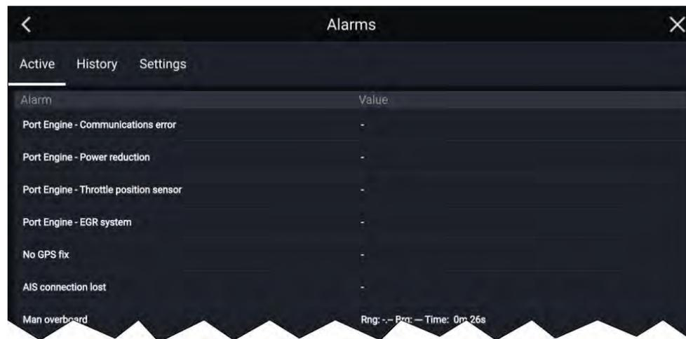
Auf der Registerkarte „Aktive Alarme“ sehen Sie alle Alarme, die gegenwärtig aktiv sind. Die Alarme bleiben so lange aktiv, wie die Bedingungen vorliegen, die den Alarm ausgelöst haben. Beispielsweise wird ein Flachwasseralarm automatisch quittiert, wenn die Tiefe den Grenzwert wieder übersteigt.
